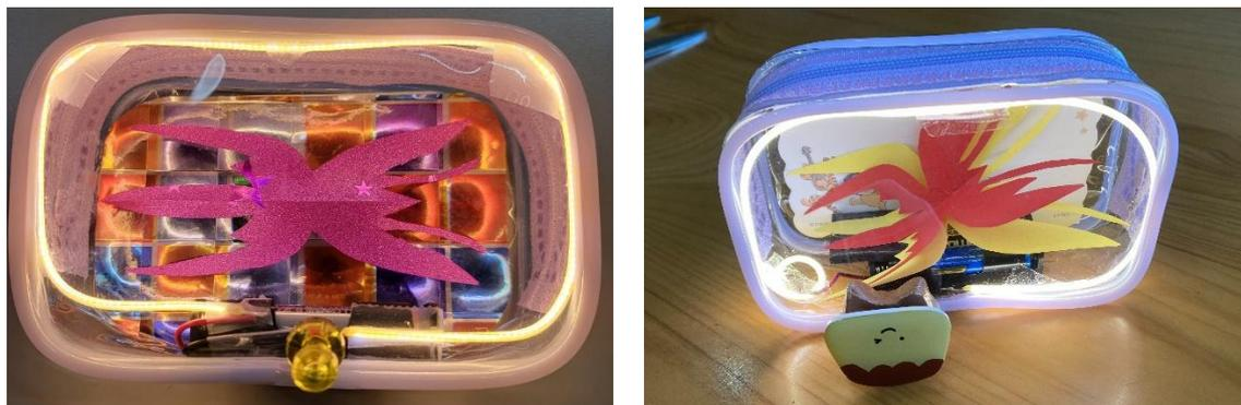
上に磁石を置いて、リードスイッチの近くに置くと点灯する。
